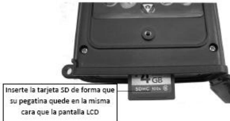
**PRECAUCIÓN:** Apague siempre la cámara al modo OFF ANTES de instalar o quitar las pilas o la tarjeta SD.
